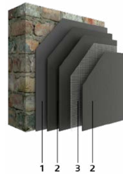
1 Grundbeschichtung 2 Abdichtung 3 Bewehrung/Armierung
